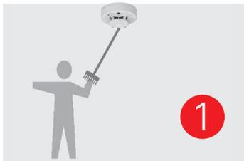
Drücken Sie **1 Sekunde** die Benutzer-Taste (z.B. unter zur Hilfenahme eines Besenstiels).
